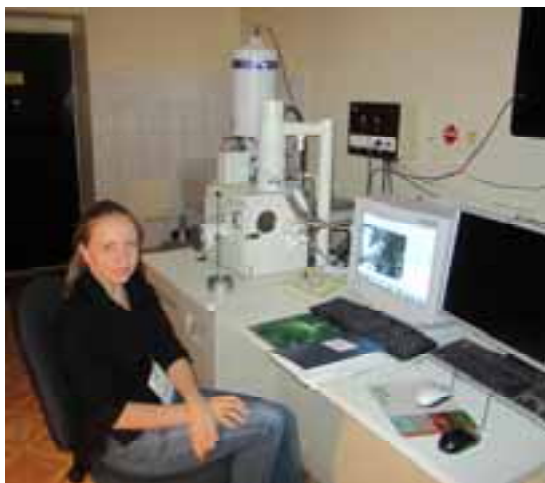
Исследование образцов с помощью растрового электронного микроскопа (JEOL JSM640)
