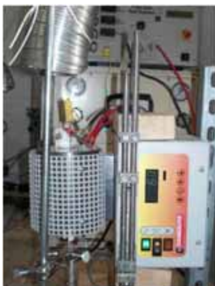
Рис. 3. испытательный стенд "CARBOLITE" для топливных элементов.
