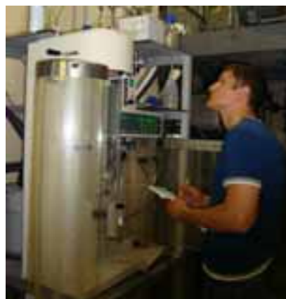
Работа на установке для распылительной сушки.
