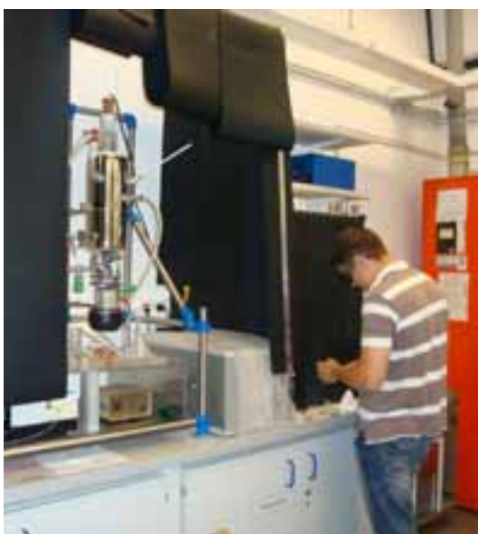
Работа на установке для фотокаталитического разложения органических примесей.
