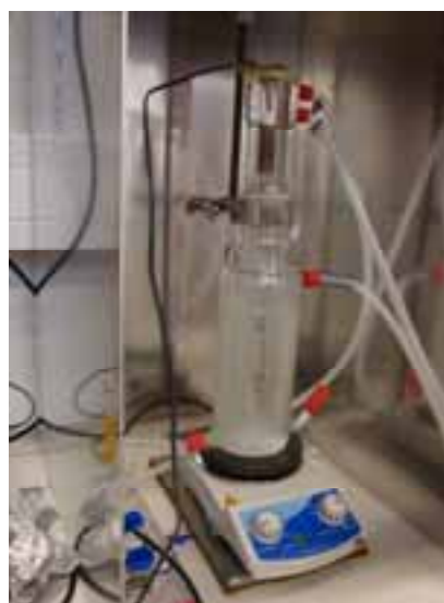
Установка для фотоэлектрохимического разложения воды.
