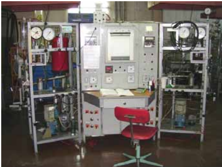
Рис. 1. Пилотная циркуляционная установка гидроочистки дизельных фракций в ИППУ СО РАН
